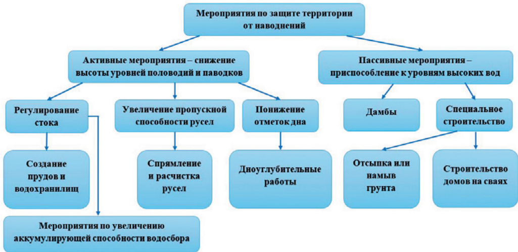
Рис. 3. Общая схема мероприятий по защите территории от затопления [5, 7]. Fig. 1. The scheme of measures intended to protect the territory against flooding [5, 7].
