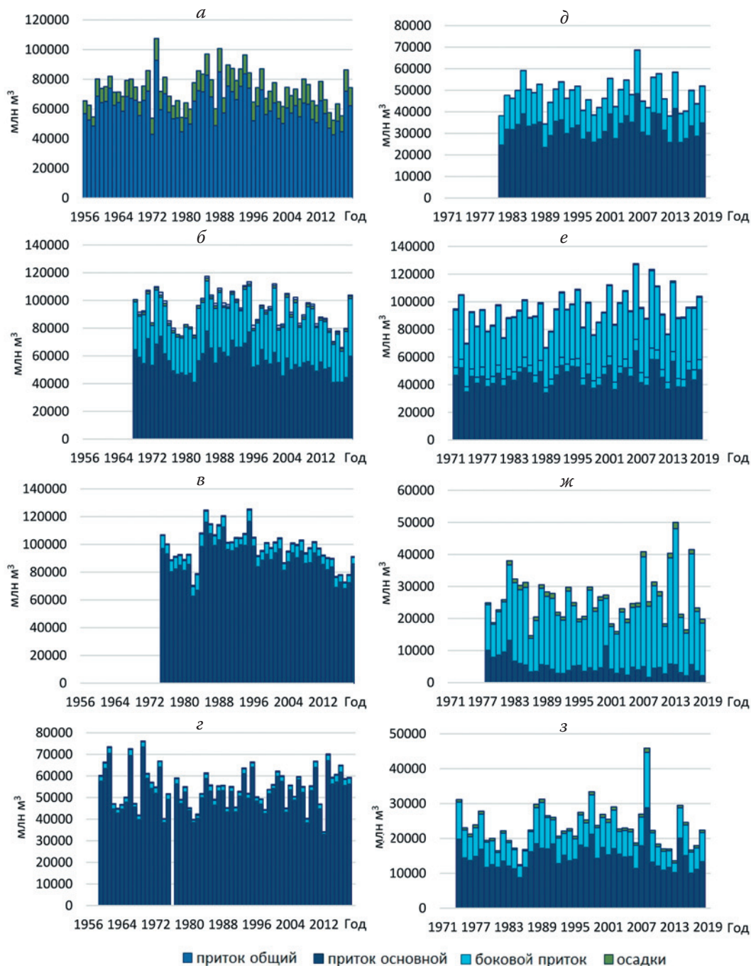
Рис. 1. Составляющие приходной части водного баланса (млн м³/год) Иркутского ( a ), Братского ( б ), Усть-Илимского ( в ), Новосибирского ( г ), Саяно-Шушенского ( д ), Красноярского ( е ), Зейского ( ж ) и Вилюйского ( з ) водохранилищ. Fig. 1. Components of the incoming part of the water balance (million m³/year) of Irkutsk ( a ), Bratsk ( б ), Ust-Ilimsk ( в ), Novosibirsk ( г ), Sayano-Shushensk ( д ), Krasnoyarsk ( е ), Zeya ( ж ) and Vilyuisky ( з ) reservoirs.
