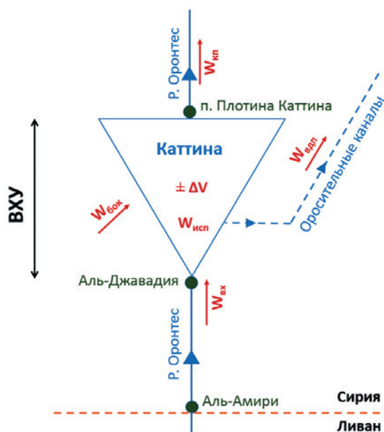
Рис. 1. Линейная схема верхнего течения р. Оронтес (Эль-Аси) до створа плотины Каттина.
