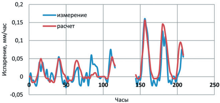
Рис. 4. Сопоставление расчетных и измеренных на БГИ величин испарения со снега с 26 февраля по 3 марта 1958 г.
