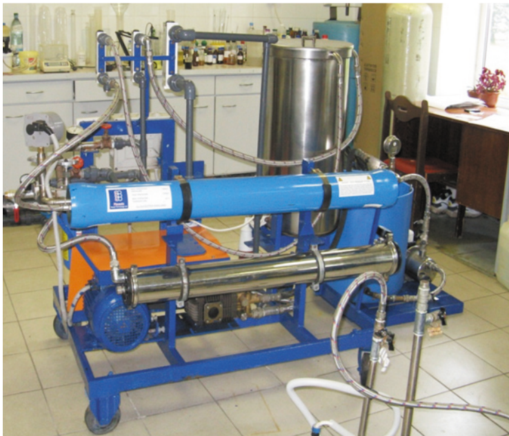
Рис. 1. Экспериментальная мембранная двухступенчатая установка обратного осмоса. Fig. 1 Experimental membrane two-stage apparatus for reverse osmosis.
