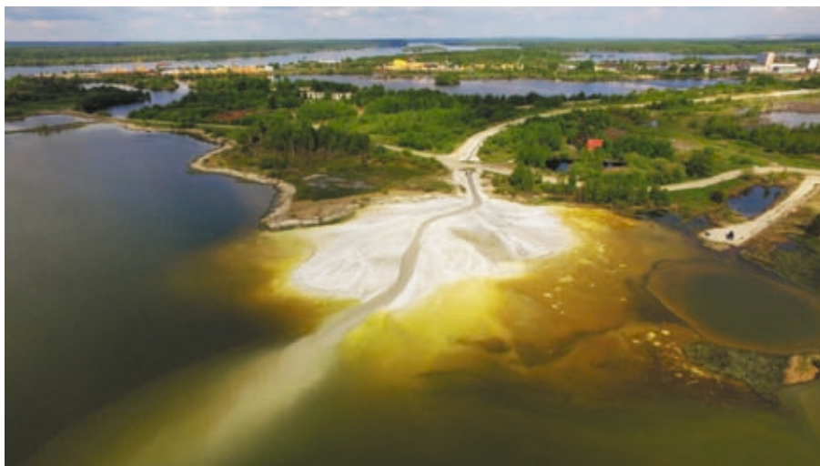
Рис. 4. Общий вид области осаждения взвешенных наносов в зоне воздействия водовыпуска ОАО «СМЗ» на пруд-отстойник, август 2020 г.
