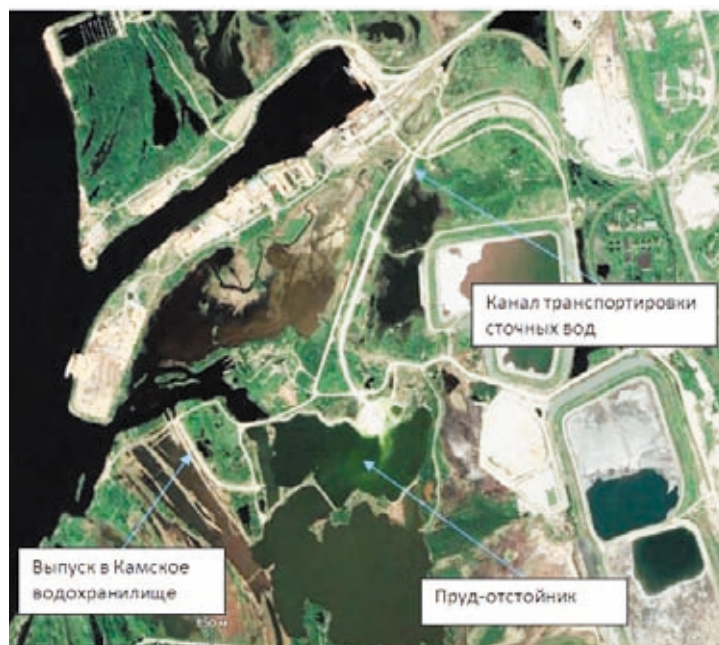
Рис. 3. Общая схема системы отведения сточных вод ОАО «СМЗ» с прудом-отстойником.
